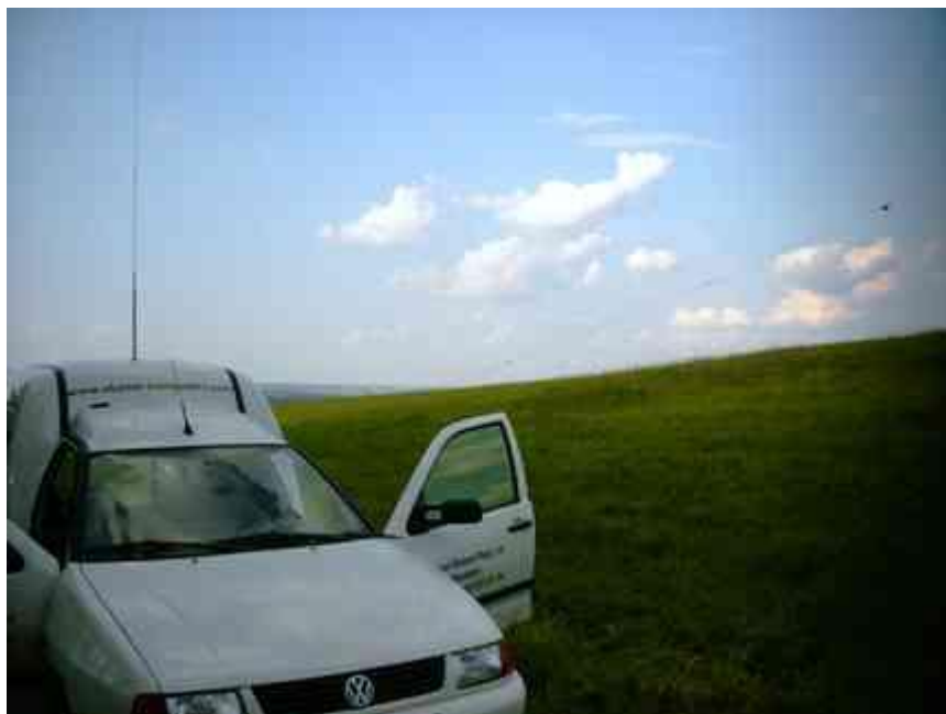
MALDOL HFC-40L für 7 MHz auf dem Fahrzeugdach meines VW Caddy
