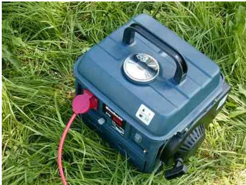
Stromaggregat EINHELL STE-800 liefert 220V/650W mit Zweitaktmotor Benzin
